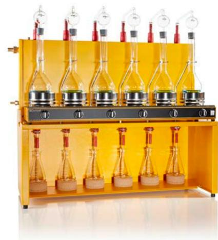
Para matraz Kjeldahl en los tamaños 50, 100, 250, 500 y 750 ml. Las posiciones de calentamiento se pueden regular por separado de forma continua. Con matraces Kjeldahl, accesorios Reitmair, tubos condensadores, tubos de salida, matraces Erlenmeyer, todas las conexiones de goma, soportes y cable de red.
